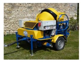
Une machine conçue spécialement pour la projection des enduits artisanaux et béton de chaux, de terre et de chanvre
